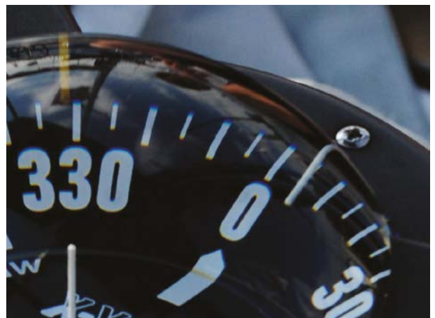
Als Steuerkompass geeigneter Magnetkompass
